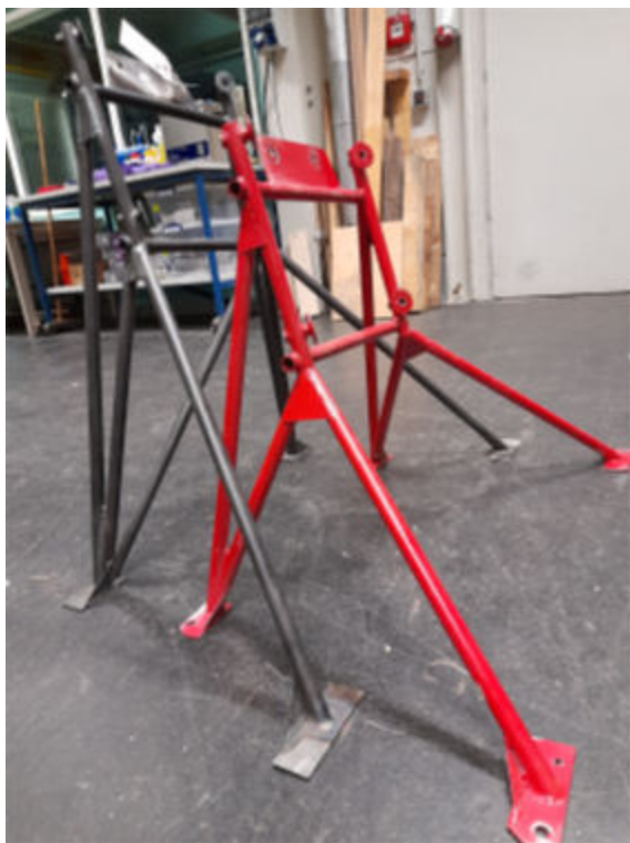
Alter und neuer Motorträger im Vergleich
