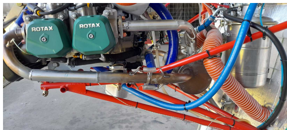
Verlängerte und in der Form geänderte Auspuffkrümmer
